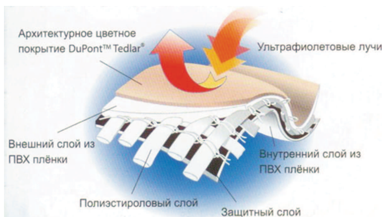
Рисунок 10. Структура ПВХ-ткани
